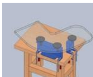
1. Mocowanie za pomocą zacisku 2. Mocowanie za pomocą śruby próżniowych
